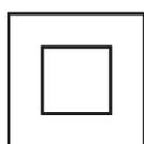
**Avertisment!** Această unealtă prezintă izolare dublă; prin urmare, nu este necesară împământarea. Verificați întotdeauna ca alimentarea cu energie să corespundă tensiunii de pe plăcuța cu specificații.
