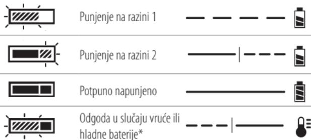
\*Crveno svjetlo nastaviti će treperiti, no žuta indikatorska lampica ravnomjerno će svijetliti kada je ova funkcija aktivna. Kada baterija postigne odgovarajuću temperaturu, žuta lampica će se isključiti, a punjač će nastaviti s punjenjem.
