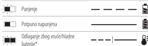
\*Crvena lampica nastavlja sa treperenjem, ali žuta indikatorska lampica nastavlja da svetli tokom ove operacije. Čim baterija dostigne prikladnu temperaturu, žuta lampica se isključuje i punjač se vraća opet u postupak punjenja.
